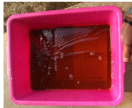
Gambar 3.6.6 Etching PCB dengan Ferri Klorida
