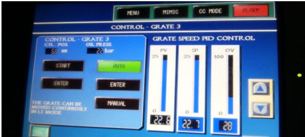
Gambar 5.7 PID controllers pada grate 3
