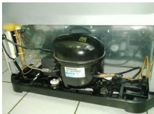
Gambar 3.19, Memeriksa Kabel Penghubung
