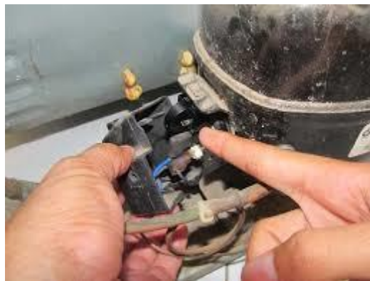
Gambar 3.18, Memeriksa Compressor dingin atau tidak
