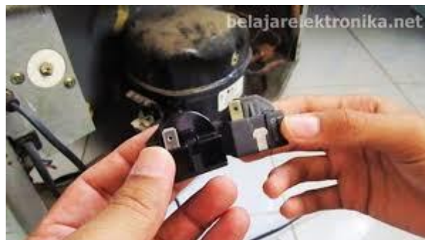
Gambar 3.19, Memeriksa Kabel Penghubung
