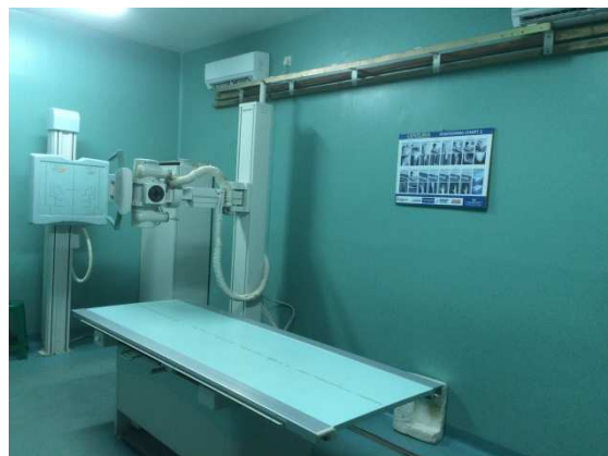
Gambar 3.1.1 dan 3.1.2 Pesawat X-Ray Konvensional dengan Kontrol Panel Digital
