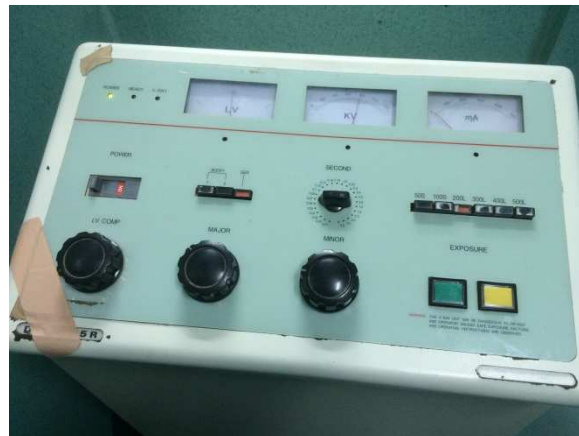
Gambar 3.1.5 Kontrol Panel Analog pada Pesawat X-Ray Konvensional.
