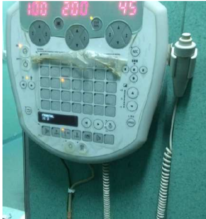
Gambar 3.1.3 Kontrol Panel Digital dari Pesawat X-Ray Konvensional.
