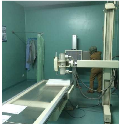
Gambar 3.1.6 Pesawat X-Ray Konvensional dengan Kontrol Panel Analog.
