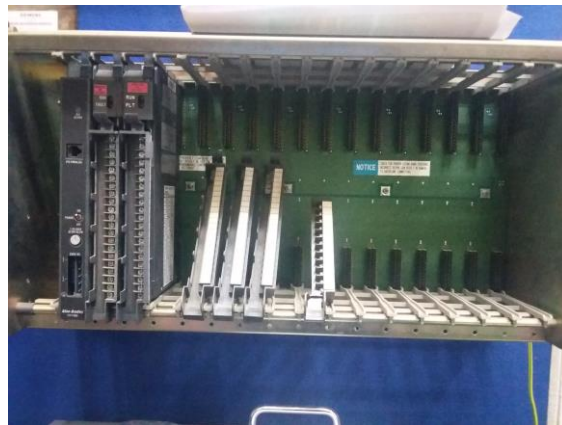
Gambar. 3.10. PLC Allen Bradley 5 80e
