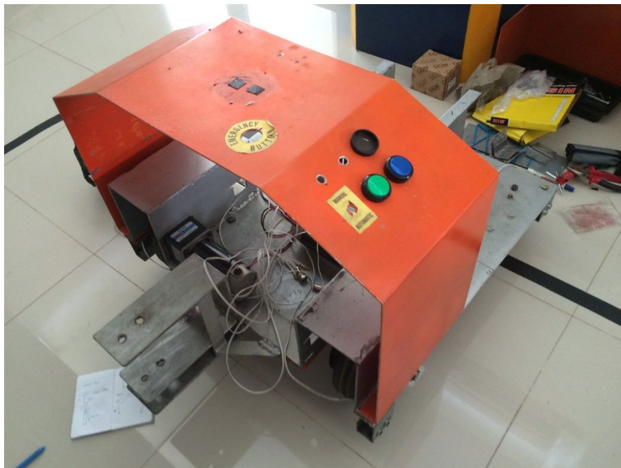
Lampiran 4. Tampak atas robot AGV
