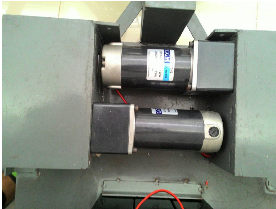
Lampiran 7. Motor DC 24 volt, dan gearbox.
