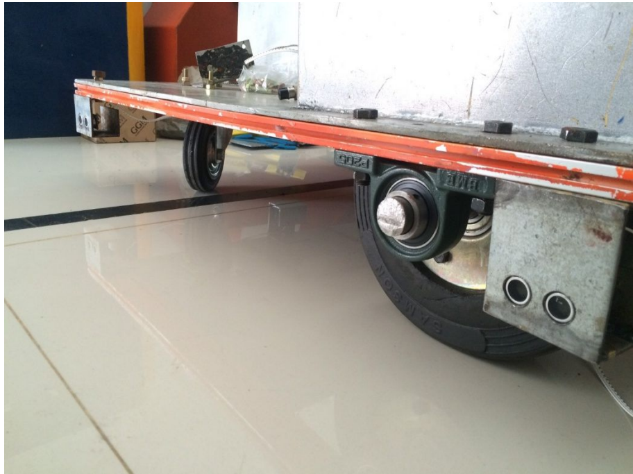
Lampiran 5. Tampak samping bawah robot AGV dan tempat penempatan sensor ultrasonik
